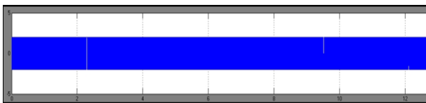
Рис. 35. Шумовая помеха. Осциллограмма сигнала и помехи на выходе ограничителя. Уровень ограничения - 2. Отношение помеха/сигнал g=145
