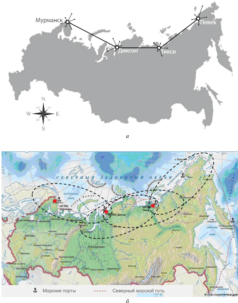
Рис. 2. Зона покрытия ИТКС МС СМП: а – межцентровая связь, б – региональные зоны покрытия
