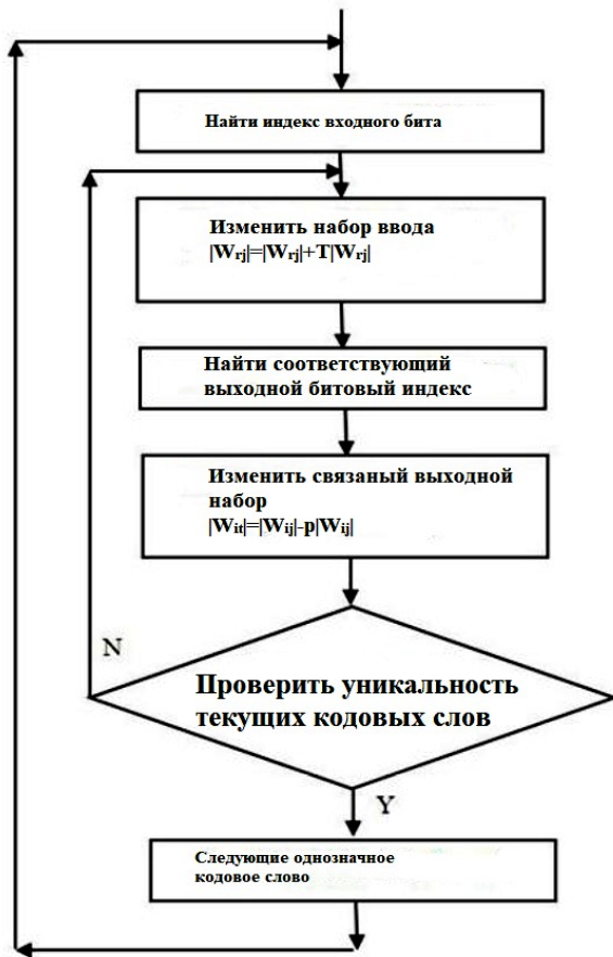
Рис. 7. Алгоритм проверки уникальности кодовых слов
